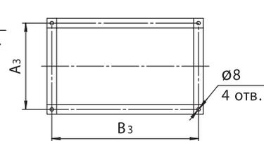
**Расположение отверстий крепления вентиляторов**
