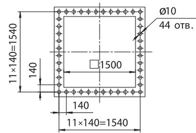
**Выходной фланец вентиляторов**
