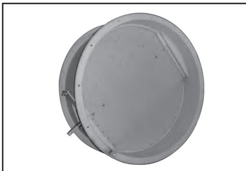
**НЕРПА®-КО** — это воздушные обратные клапаны высокой плотности, разработанные для автоматического перекрытия воздухопроводов при отключении вентилятора. Обратные клапаны НЕРПА®-КО имеют гравитационный тип действия и предназначены для работы в вентиляционных сетях высокого давления в условиях резких перепадов рабочего давления в сети, а также для герметизации внутреннего объема вентиляционных сетей. Клапаны НЕРПА®-КО не имеют аналогов в отечественном производстве.
