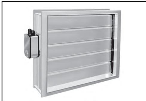
**РЕГЛАН** — это клапан, предназначенный преимущественно для регулирования расхода приточного, рециркуляционного или вытяжного воздуха в системах вентиляции и кондиционирования, а также для герметизации внутреннего объема вентиляционных сетей, рабочее давление которых не превышает 1200 Па.
