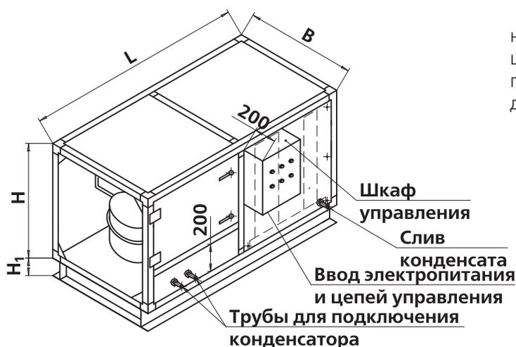
Блок состоит из полностью встраиваемого фреонового испарителя и полноценной холодильной машины, состоящей из герметичного поршневого компрессора, ресивера, ТРВ и других элементов необходимых для автономного функционирования.
