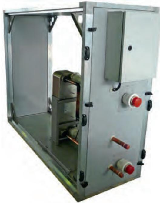
БВК предназначен для охлаждения и последующей конденсации хладагента, циркулирующего в замкнутой холодильной системе. Отвод тепла осуществляется через теплопередающую поверхность теплообменника, охлаждаемую водой, подаваемой от системы обратного водоснабжения предприятия, либо от драйкулера.
