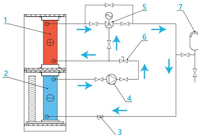
1. теплообменник-нагреватель (приток); 2. теплообменник-охладитель (вытяжка); 3. фильтр-грязевик; 4. циркуляционный насос (поставка ВЕЗА); 5. клапан трехходовой с электроприводом (поставка ВЕЗА); 6. балансировочный клапан; 7. мембранный расширительный бак
