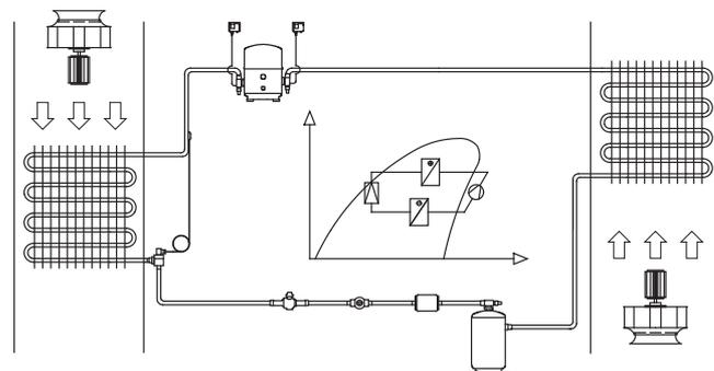
Представляет собой готовую холодильную установку включающую в себя испаритель, герметичный поршневой, или спиральный, компрессор, ресивер, конденсатор, терморегулирующий вентиль и прочую холодильную арматуру и автоматику.
