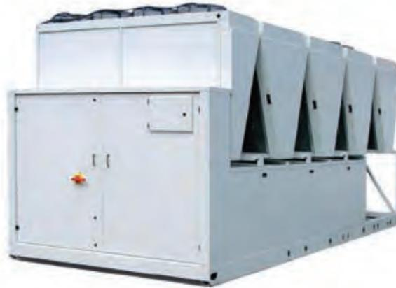
АКВА-МАКК – это водоохлаждающий агрегат (чиллер) для наружного монтажа, производства компании «ВЕЗА». Выполнен в едином корпусе, в состав которого входят: конденсатор, вентилятор, компрессор, испаритель, холодильная автоматика, блок управления и коммутации.
