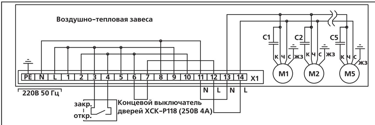
**Алгоритм работы:** Включение воздушной завесы происходит при срабатывании концевого выключателя при открытии дверей.
