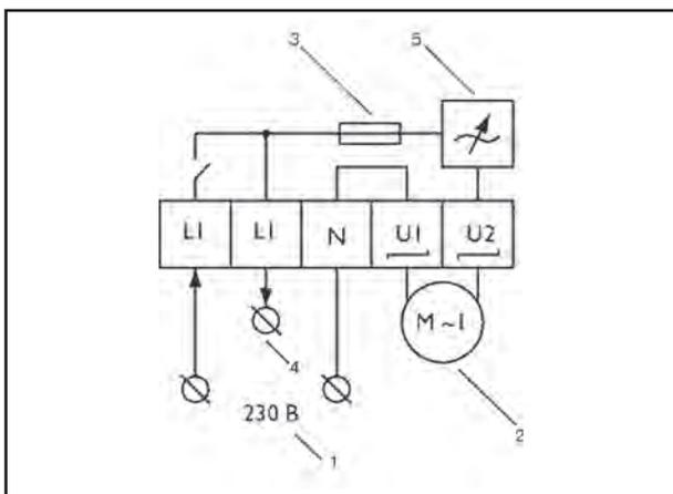
Регулирование скорости электродвигателей осуществляется вручную с помощью выбора требуемого положения ручки регулятора. Стандартное выходное напряжение плавно изменяется в диапазоне 0-230 В.
