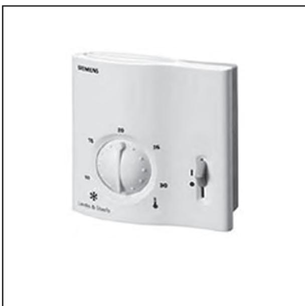
Комнатный термостат работает от газонаполненной мембраны. Когда температура в помещении опускается ниже заданного значения, термостат замыкает выходной контакт. Если температура в помещении поднимается выше заданного значения, термостат размыкает выходной контакт. Требуемая температура в помещении задается совмещением стрелки на ручке настройки с требуемым значением на лицевой панели термостата.
